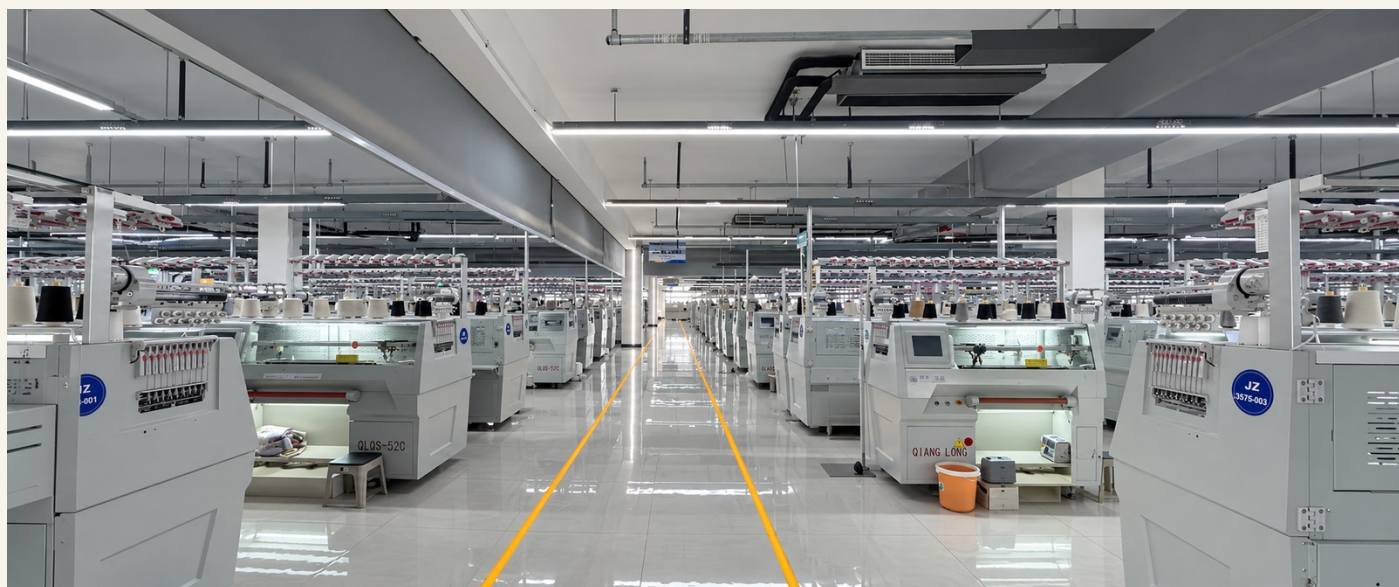
コンピューター横編機による編成現場 / 中国・山東省海陽市
